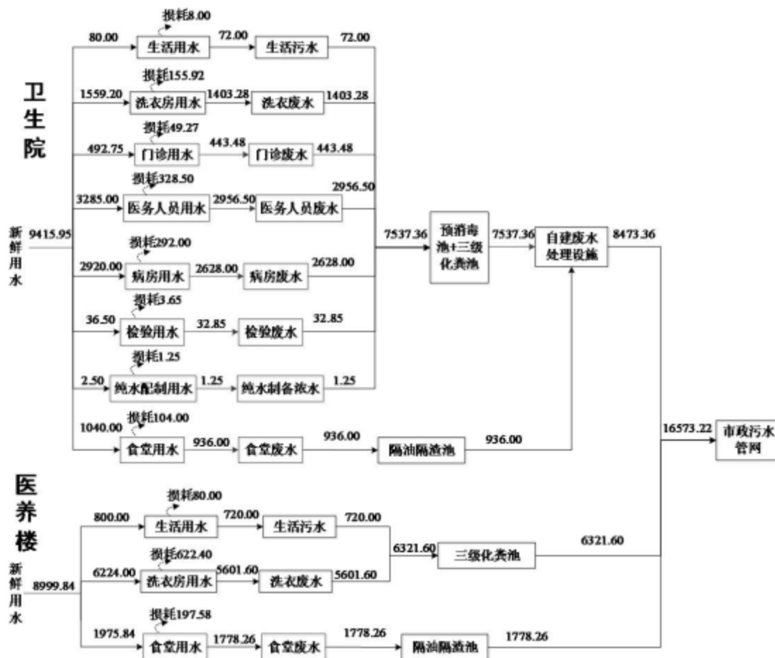
图 3.5-1 本项目给排水平衡图 (单位: m³/a)
